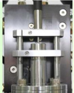
Высокоточный LVDT-датчик встроенный в актуатор
